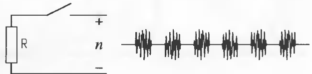
Рис. 1. Резистор генерирует белый тепловой шум. Переключатель периодически открывается и закрывается, так что шум на выходе — циклостационарный.
